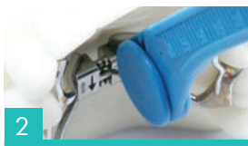
2 Inserire la chiavetta con stop nel foro della vite individuato
